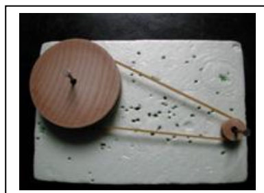
2 poulies et une courroie
