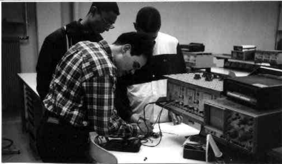
Photo 1 :test de la carte imprimée.
