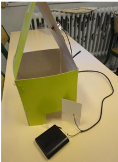
13 La batterie ou pile plate va amener le courant. Pour allumer l'ampoule, on doit fermer le circuit.
